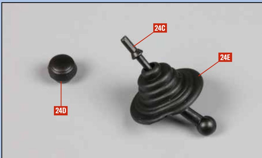
**2** Stecken Sie den Schalthebel **24C** in die Schutzkappe **24E**, wie es das Foto zeigt. Legen Sie den Schalthebelknopf **24D** auf Ihre Arbeitsplatte.
