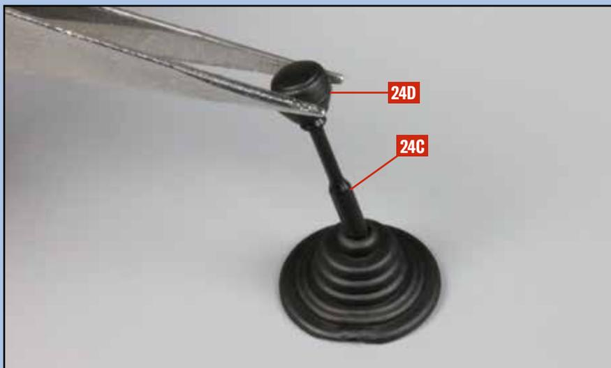
**3** Nehmen Sie den Schalthebelknopf **24D** und platzieren Sie ihn auf dem schmaleren Ende des Schalthebels **24C**, wie dargestellt.
