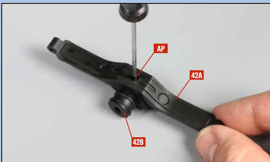
**3** Befestigen Sie den Wellenflansch **42B** mit der Schraube **AP** an der Halterung **42A**, wie es das Foto zeigt.
