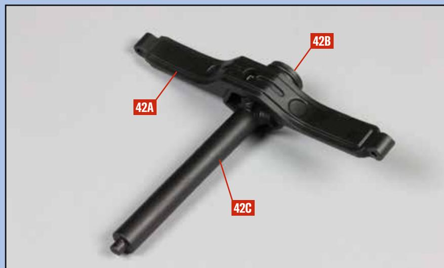
**5** Der hintere Abschnitt der Antriebswelle **42C** ist mit dem Wellenflansch **42B** verbunden.
