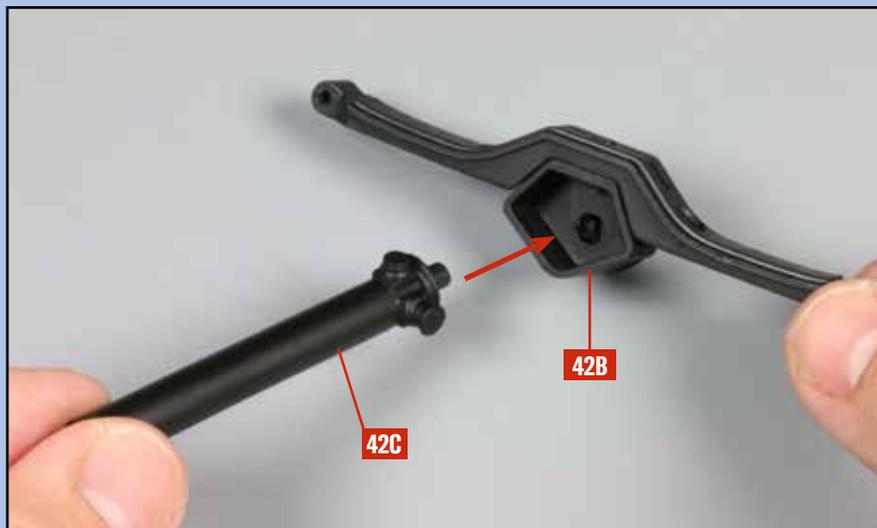
**4** Nehmen Sie nun den hinteren Abschnitt der Antriebswelle **42C** und führen Sie ihn zum Wellenflansch **42B**, wie angedeutet.
